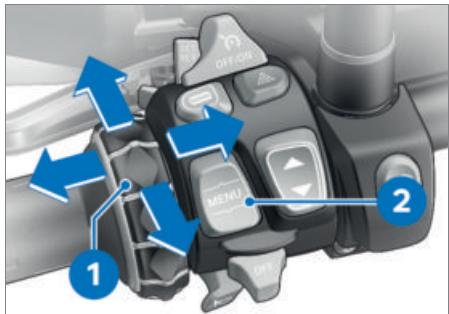
La commande du système de navigation s'effectue par l'intermédiaire du Multi-Controller **1** et le changement de focus au moyen de la touche basculante à retour MENU **2**.
